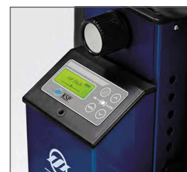
Nuevo panel de control digital que permite introducir al cuidador diversos parámetros (velocidad, modo de subir las escaleras -individualmente/ciclo continuo...) garantizando un uso seguro y simple del sube escaleras.
